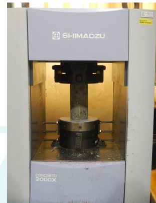
圧縮強度試験 (2000kN 耐圧機)
