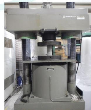
圧縮強度試験 (5000kN 耐圧機)
