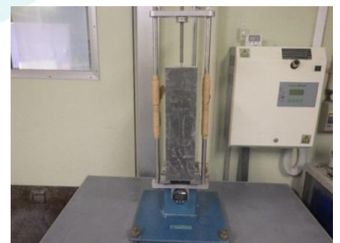
写真-7 長さ変化測定状況
