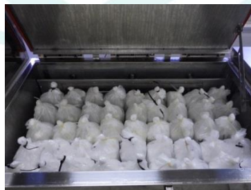
写真-6 恒温湿潤槽による養生状況
