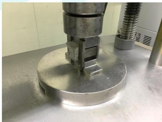
モルタルの圧縮強さの比の試験
