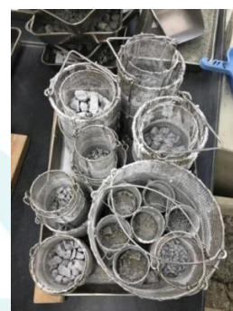
JIS A 1122 硫酸ナトリウムによる骨材の安定性試験方法
