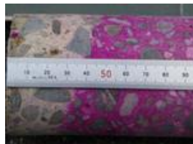
中性化測定状況【コア供試体法（側面）】
