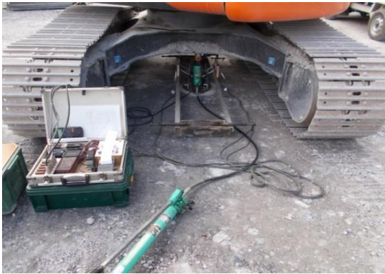
試験状況 (反力：バックホウ使用)
