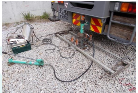
試験状況 (反力：クレーン使用)
