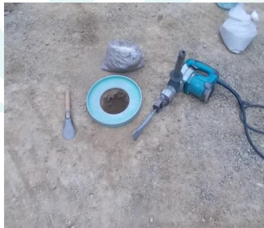
試験状況(試験孔 削孔完了)
