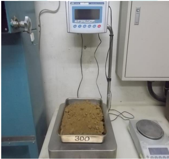
試験状況(含水比計量状況)
