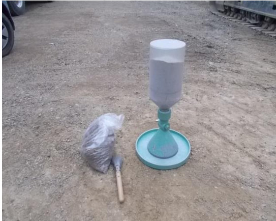
試験状況(乾燥砂充填状況)
