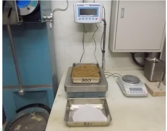
試験状況(掘削土・砂計量状況)
