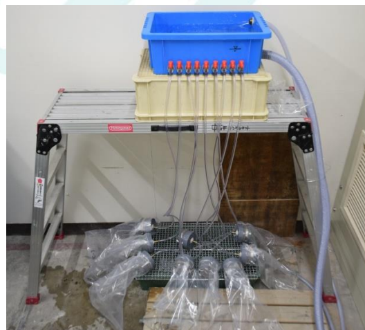
写真-4 ひび割れ透水性試験 実施状況
