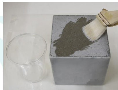
写真-1 表面含浸材の塗布状況
