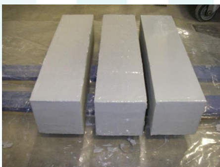
写真-4 エポキシ樹脂によるシール状況
