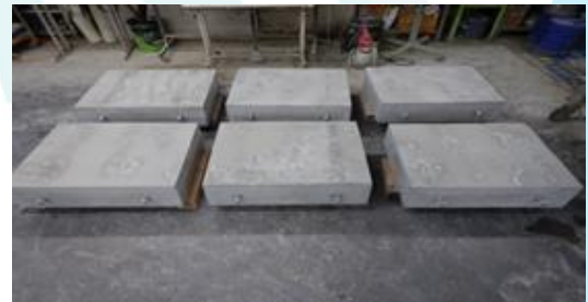
押し抜き試験用供試体の一例(繊維補強コンクリート)
