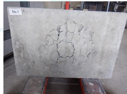
試験後の供試体(繊維補強コンクリート)
