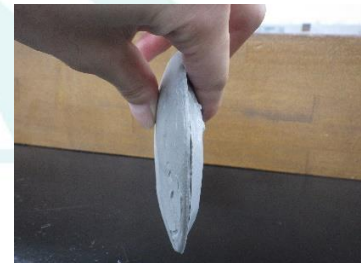
写真4 安定性試験（パット法）
