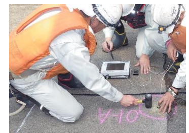
杭の健全性 測定状況
