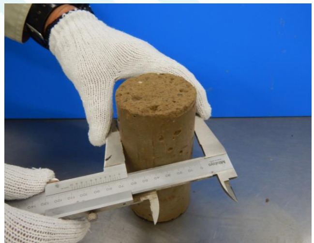
試験状況（ノギス法）
