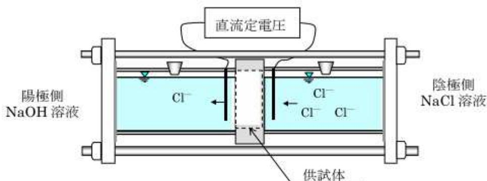
図1 電気泳動法の装置例
