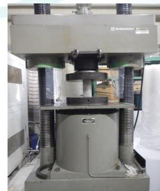
圧縮強度試験(5000kN 耐圧機)
