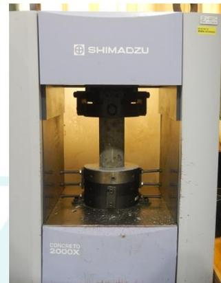
圧縮強度試験(2000kN 耐圧機)
