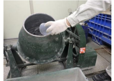
写真-2 水酸化ナトリウムの後添加状況
