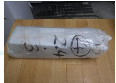
写真-5 給水紙の養生状況②
