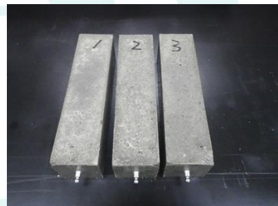
脱型後のモルタルバー供試体
