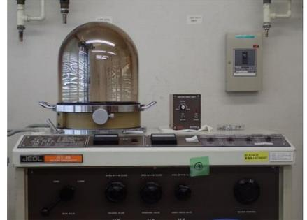
写真 2. 蒸着装置
