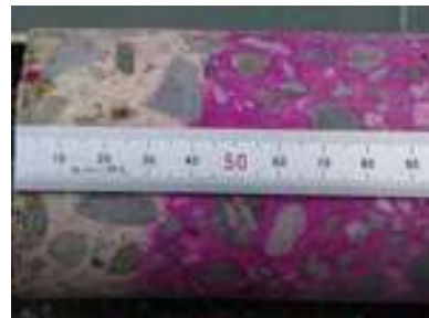
中性化測定状況【コア供試体法（側面）】
