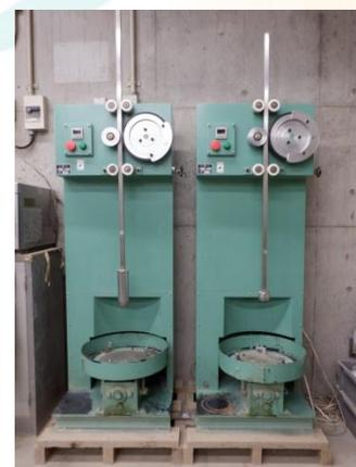
締固め試験機
