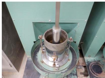
締固め試験状況
