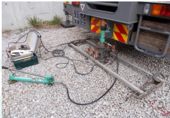
試験状況(反力:クレーン使用)
