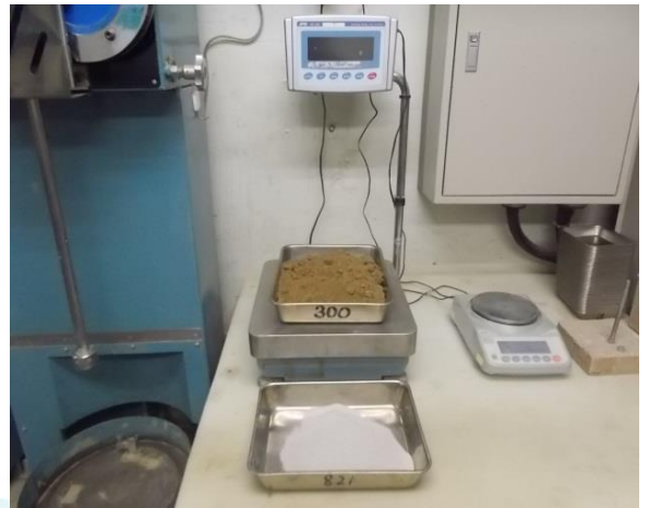
試験状況(掘削土・砂計量状況)
