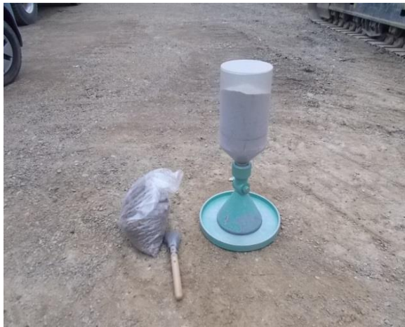
試験状況(乾燥砂充填状況)
