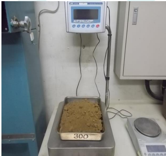
試験状況(含水比計量状況)
