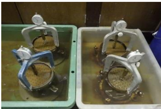
試験状況(吸水膨張試験)
