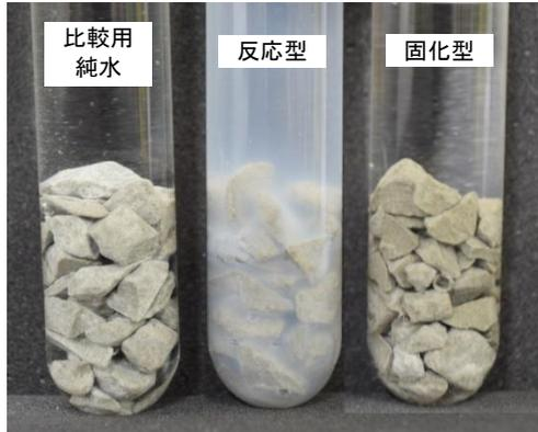
写真-2 種類判定試験 反応状況
