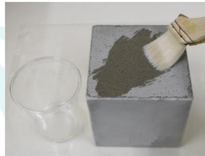
写真-1 表面含浸材の塗布状況
