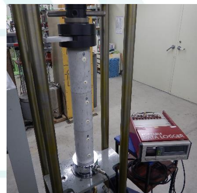
写真-1 円柱供試体試験状況
