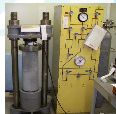
写真-2 遠心成形供試体試験状況
