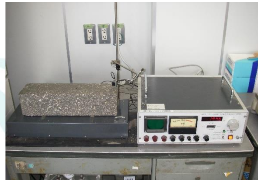
たわみ振動の一次共鳴振動数の測定
