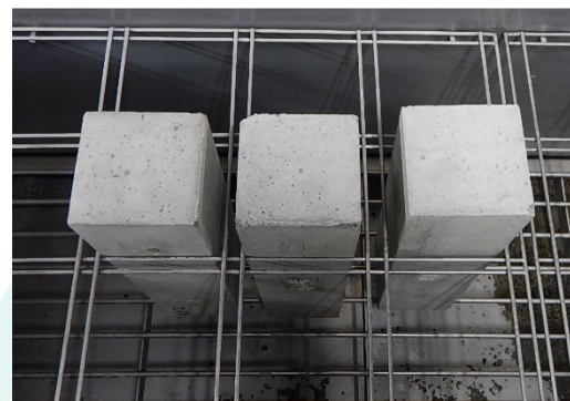
気中凍結水中融解法による試験状況 (B 法 凍結行程)
