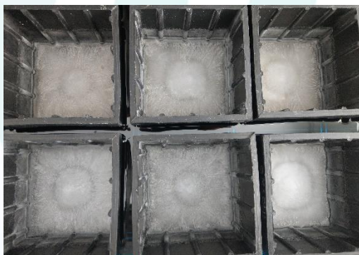
水中凍結融解法による試験状況 (A 法 凍結行程)
