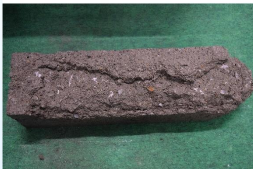
凍害によって劣化した供試体
