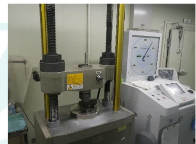
写真5 圧縮強さ試験
