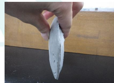
写真4 安定性試験（パット法）
