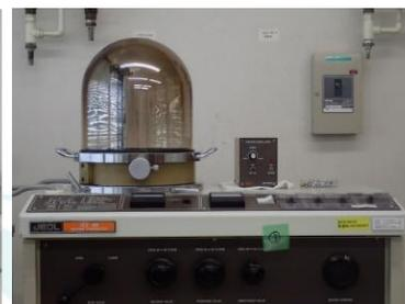
写真 4 蒸着装置
