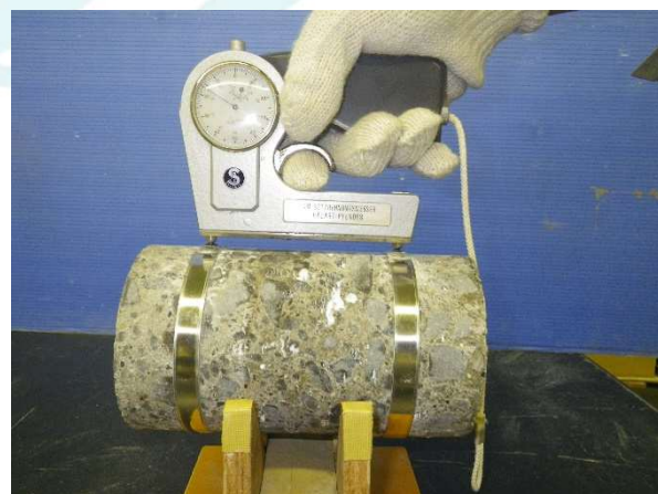
写真-3 促進膨張量試験
